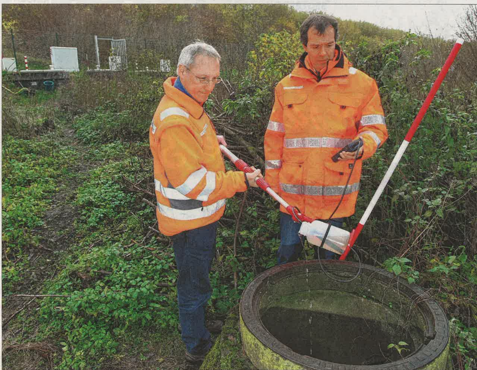
Ziehen eine Probe in einem Schacht und messen den Salzgehalt: Manfred Rehberg (51, l.) und Jürgen Adler. Foto: Lutz Roeßler
